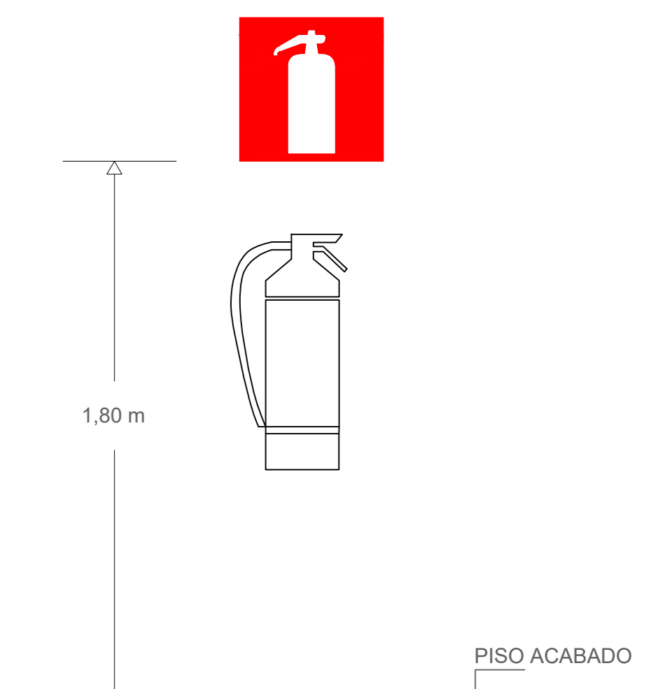
SINALIZAÇÃO DE EXTINTORES DE ESCALA
